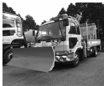
スノープラウ装着トラック
